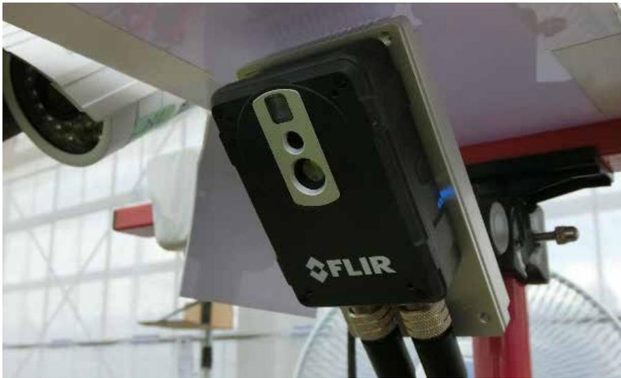
赤外線カメラFLIR AX8を使用して継続的に農作物を観測している様子。
